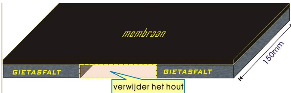
Figuur B7.12 Voorbereiding van de mal en houten plaat voor PM proefstuk
