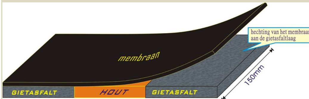
B7.10 Membraan-installatie op de bovenkant van GA
